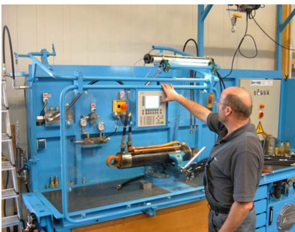
Neuer Zylinderprüfstand mit SPS und sicherheitsrelevanten Schutzeinrichtungen
