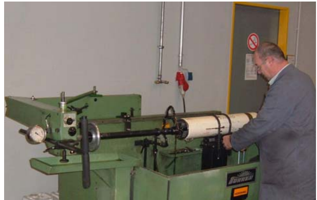
Zylinderrohre werden an der Honmaschine innen überarbeitet
