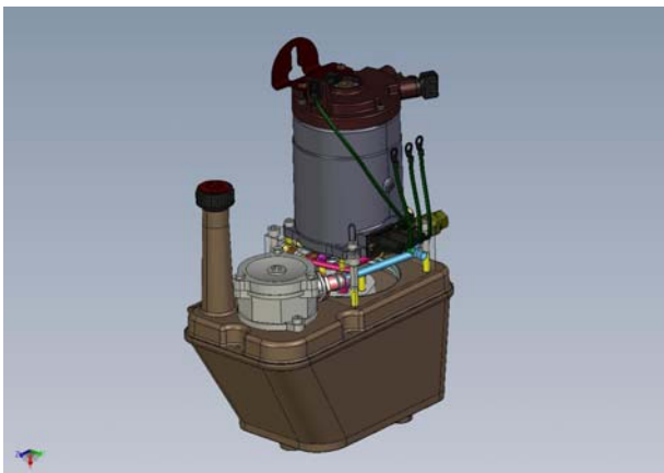
Hydraulischer Antrieb für die Lenkung im Elektro-Gabelstapler
