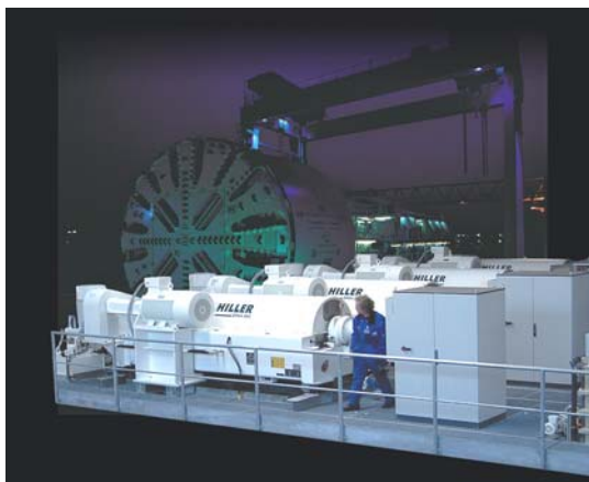
Hiller-Dekanter, die beim Bau des Finnetunnels eingesetzt werden
